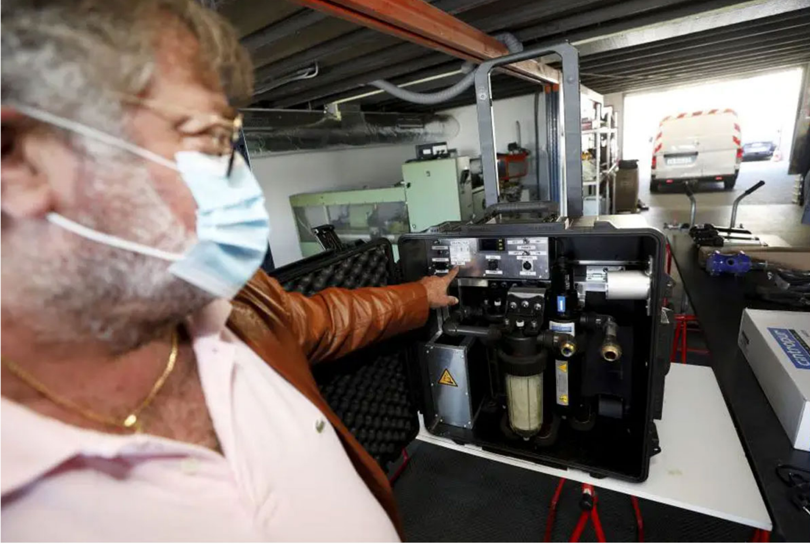
La valise Ôsauv, c'est une unité autonome de filtration de l'eau dans une valise qui peut être parachutée. Photo Dylan Meiffret
